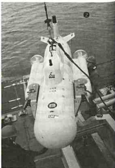
Os Veículos Submarinos Autônomos (*Autonomous Underwater Vehicle – AUV*) são os equipamentos mais modernos para a GM. Lançados por embarcações de superfície, submarinos ou aeronaves, seguem independentes de cabos de controle, com propulsão própria, para cumprirem uma derrota programada. Evitam obstáculos e decidem como ultrapassá-los. Detectam e classificam contatos sonar como as minas (foto 3).
