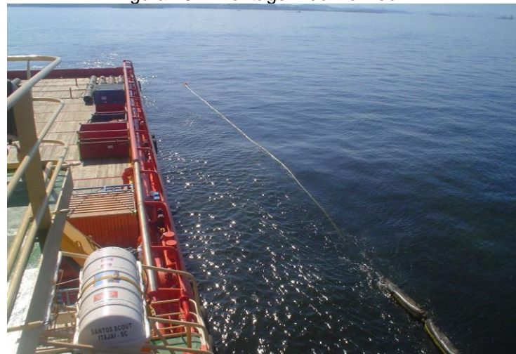
Figura 15 – Montagem do Ro-Boom
