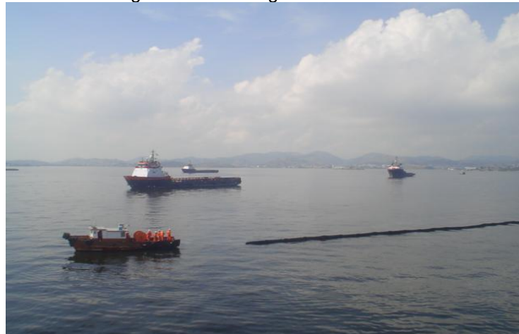
Figura 14 – Montagem do Ro-Boom
