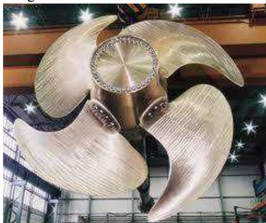
Figura 03: Hélice de Passo Controlável.
