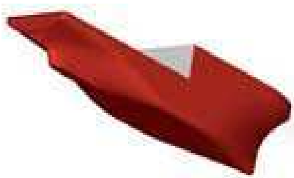
Figura 17 - Vista inferior da Forma de casco de AHTS
