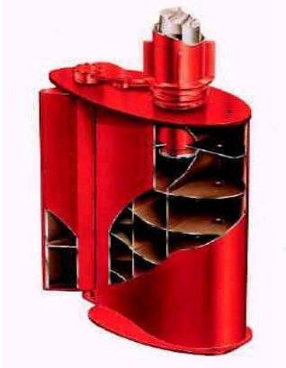
Figura 18 - Vista interior de pá de leme
