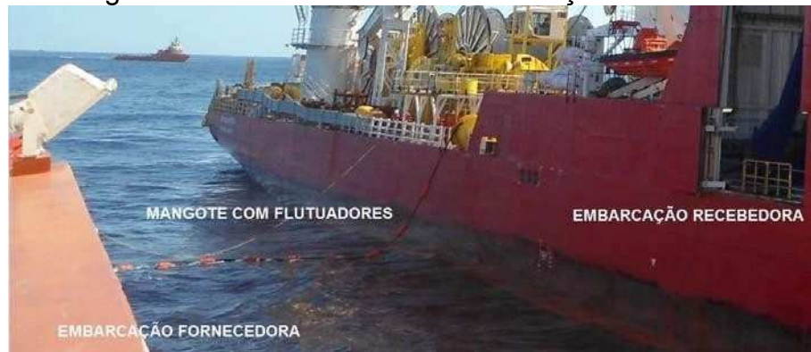
Figura 8 – Mangote conectado entre duas embarcações com flutuadores
