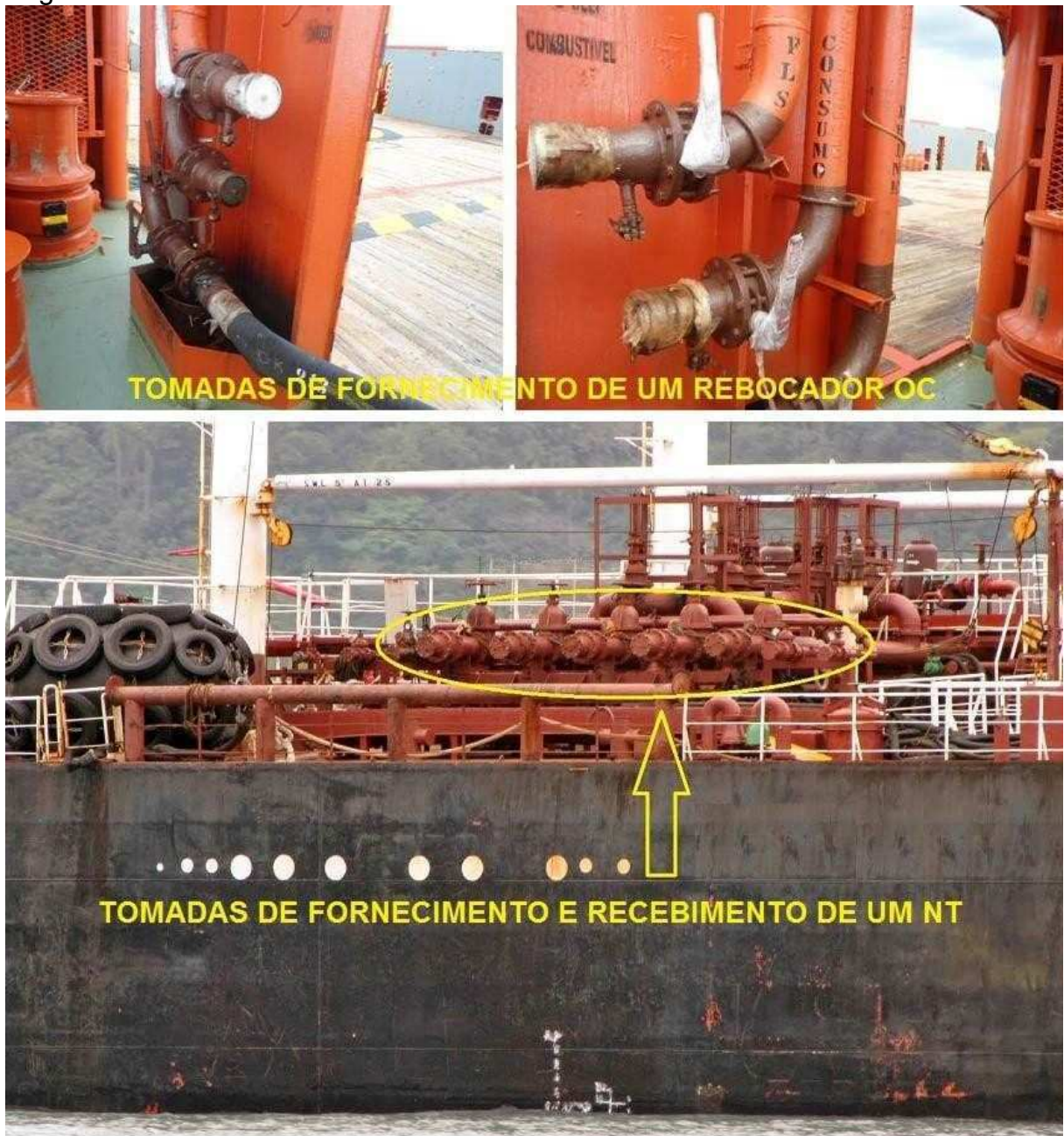
Figura 9 – Tomadas de fornecimento de combustível em rebocador e em NT
