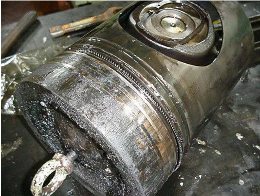
Figura 7 – Coroa de um pistão com depósitos de carbonato de cálcio
