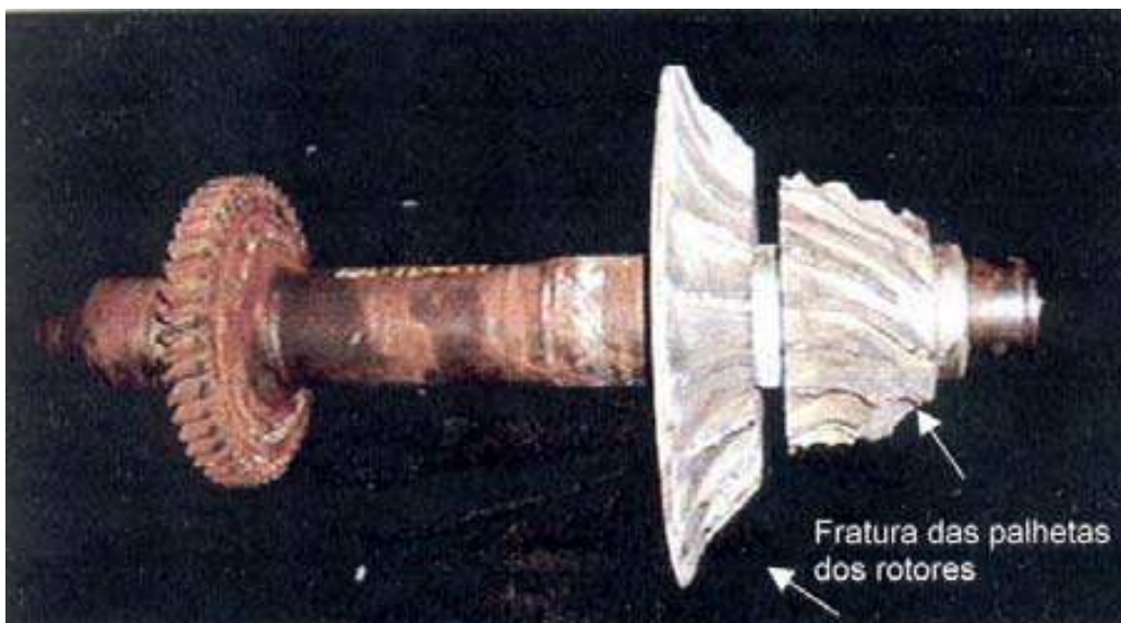
Figura 10 – Rotor de turboalimentador sem as palhetas da turbina e com a roda compressora destruída
