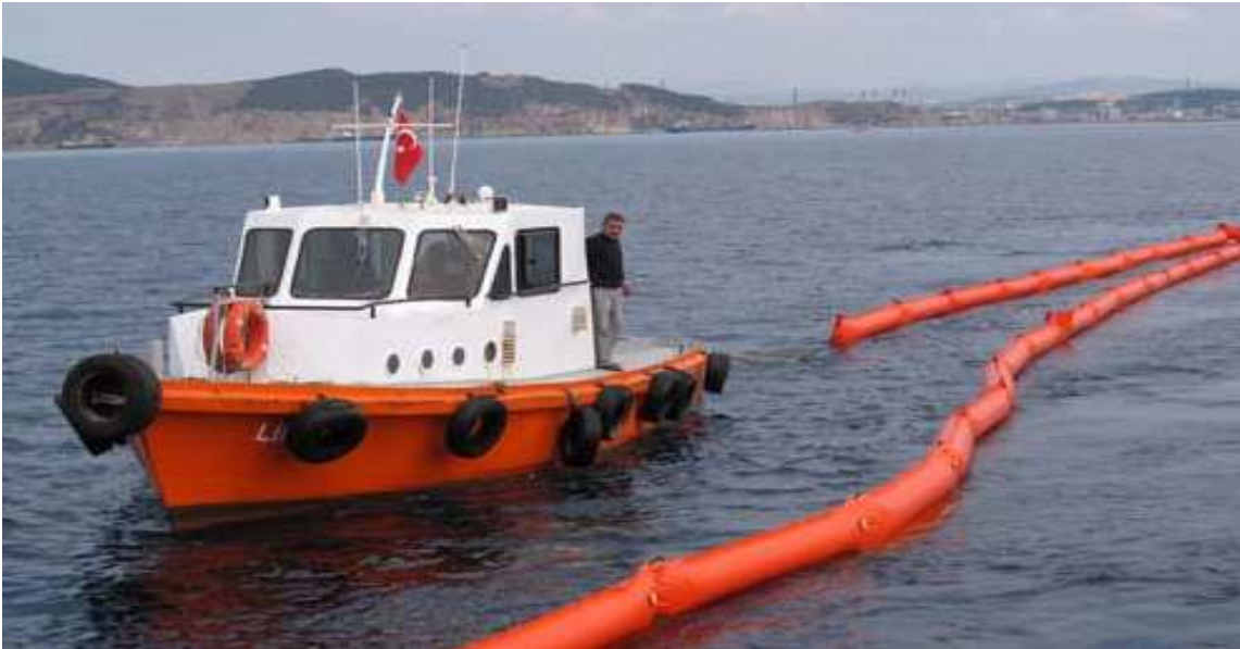
Figura 19 – Embarcação de apoio para o lançamento da barreira
