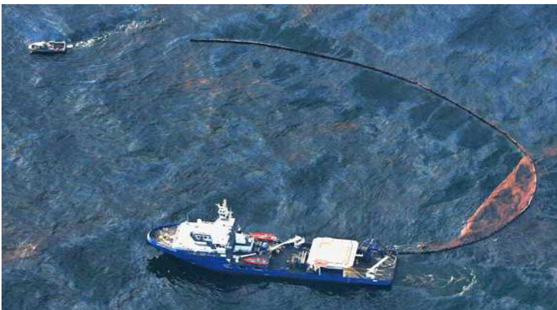
Figura 23 – Configuração de barreira em “J”
