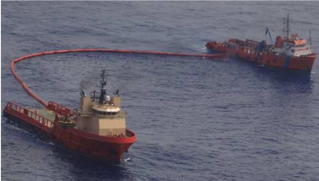
Figura 22 – Configuração de barreira em “U”
