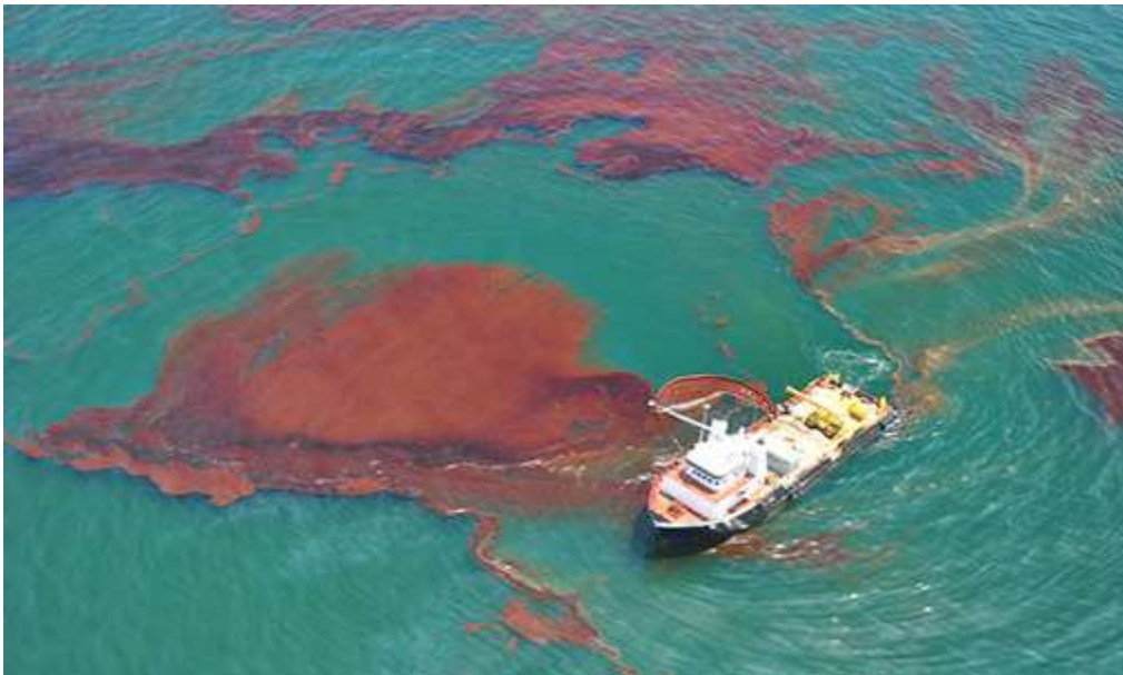
Figura 24 – Aplicação de dispersante por embarcação OSRV
