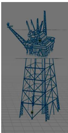
Figura 7 – Estrutura de uma plataforma fixa.
