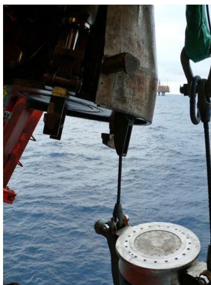
Figura 12 – Conexão do mangote no BLS.
