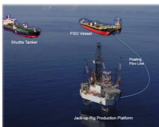
Figura 14 – FSO recebe a produção da plataforma auto elevável.
