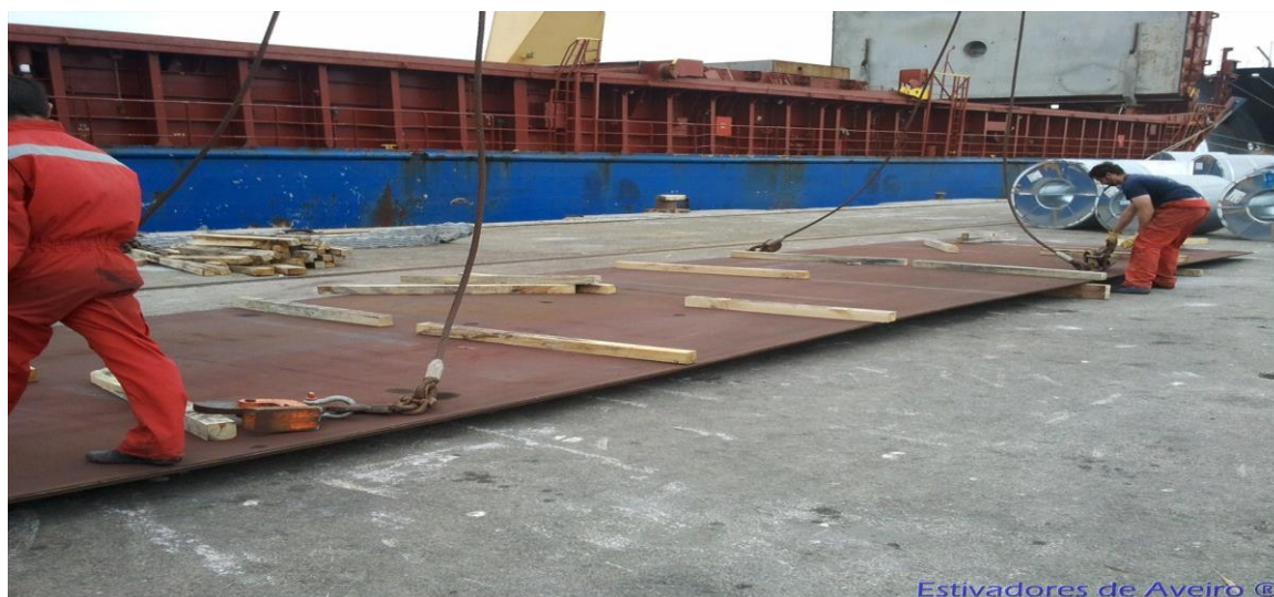
Figura 3 - Descarga a bordo de chapa de aço com patola de corrente
