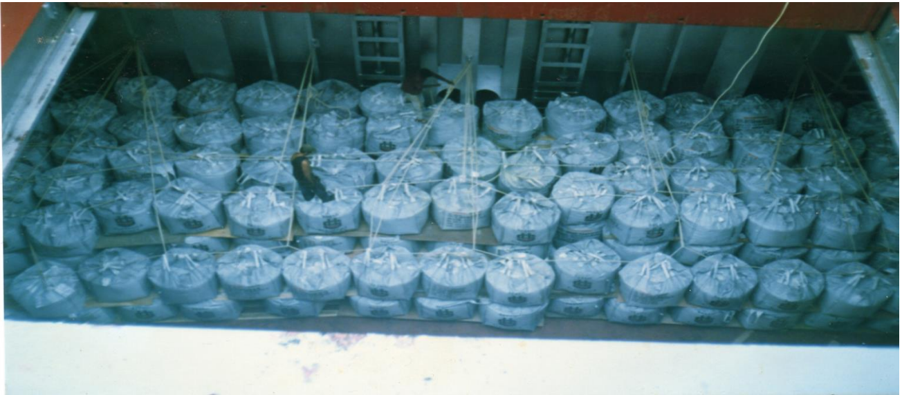
Figura 2 - Peação de big bag usando cabos de polietileno
