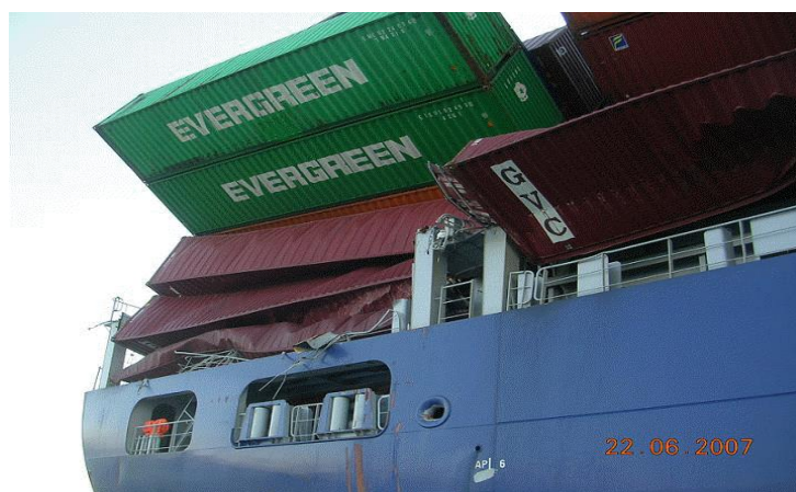
Figura 12 – Avaria de contêineres
