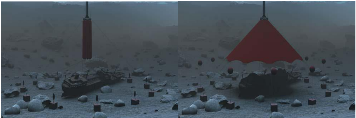
Figura 10 – Movimentação da estrutura cônica do DIFIS
