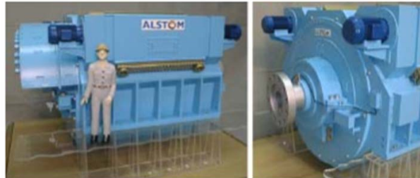
Figura 8 - O motor de Indução avançado (Multifásico com 15 fases)
