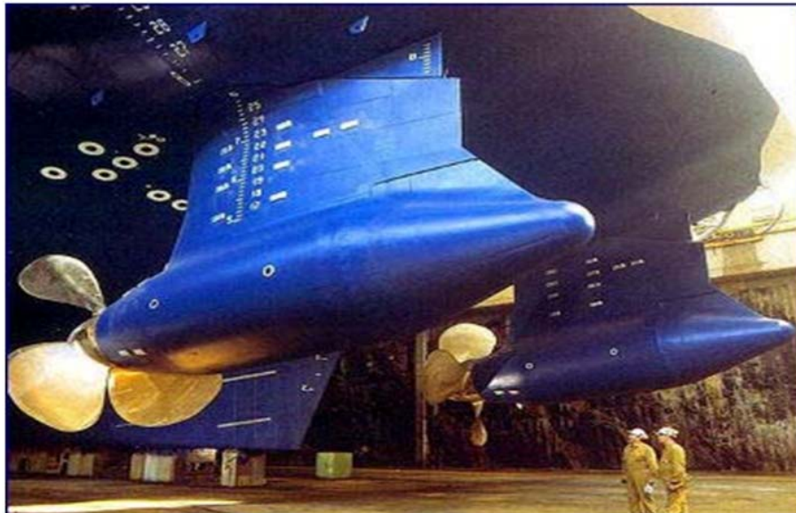
Figura 18 - Sistema de Propulsores sem Leme
