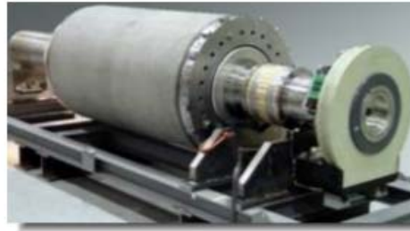
Figura 10 - Motor síncrono com material supercondutor em alta temperatura
