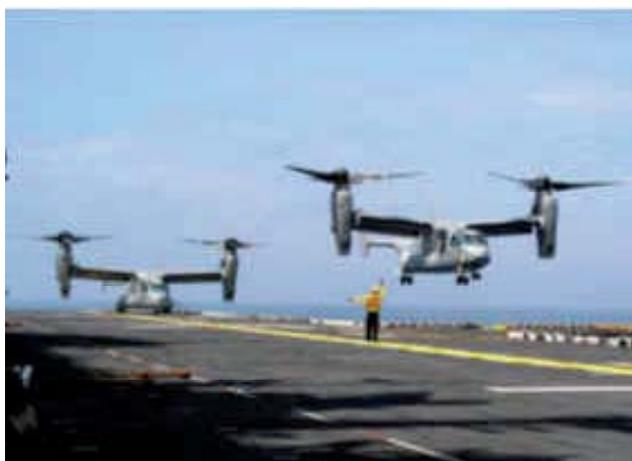
*A aeronave V-22 OSPREY, outro componente da “tríade da mobilidade”. Notar a configuração híbrida do arranjo asa-motores que revela suas atribuições tanto de ANV de asa fixa como de rotativa*
