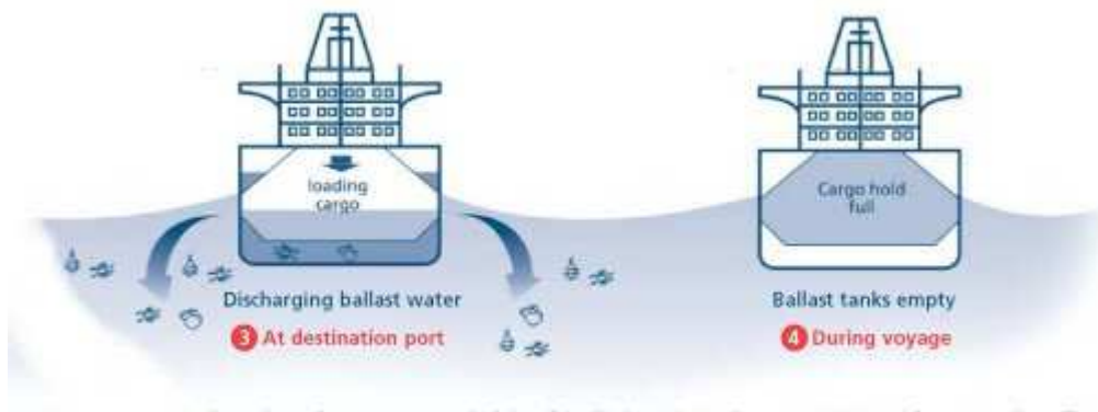
Figura 1: Esquema explicativo sobre a água de lastro
