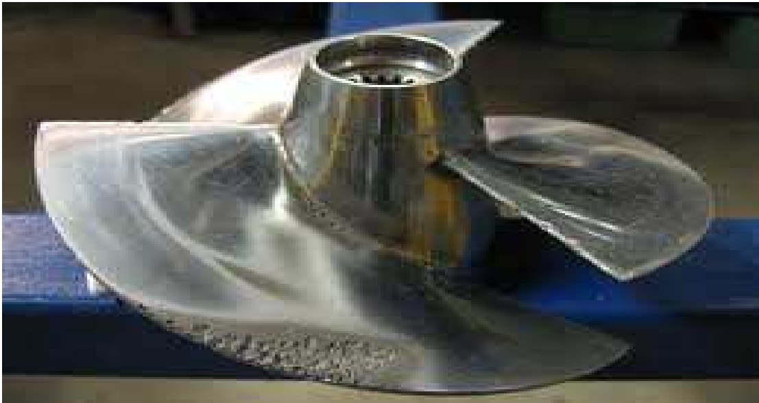
Figura 7 - Propulsor danificado pelo processo cavitação-corrosão
