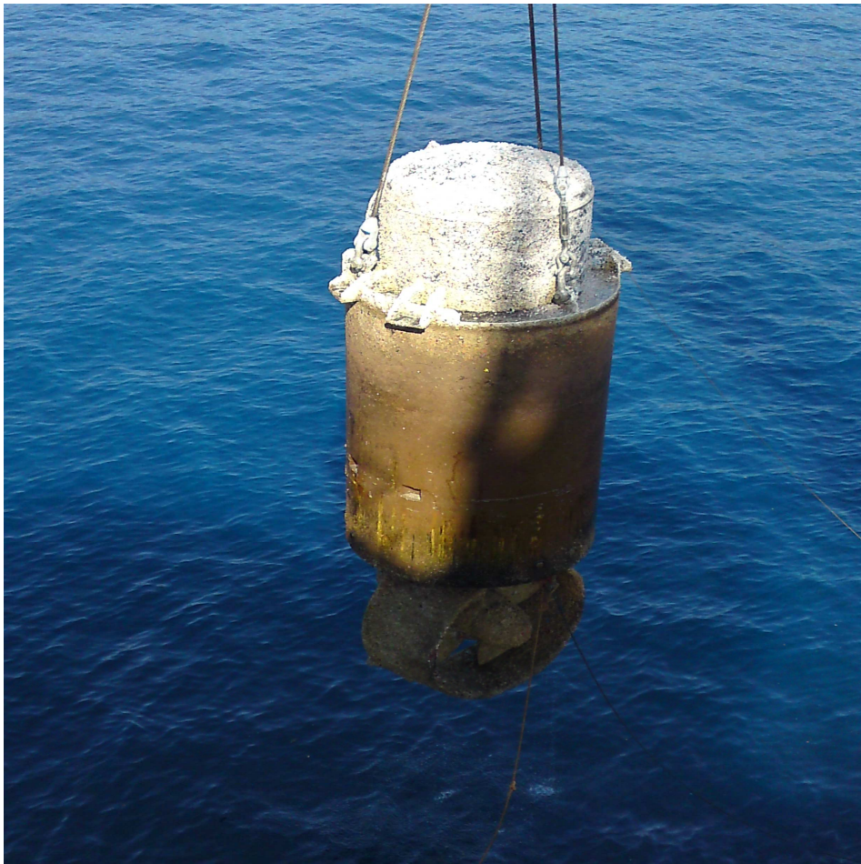
Figura 10 - Exemplo de corrosão eletroquímica.
