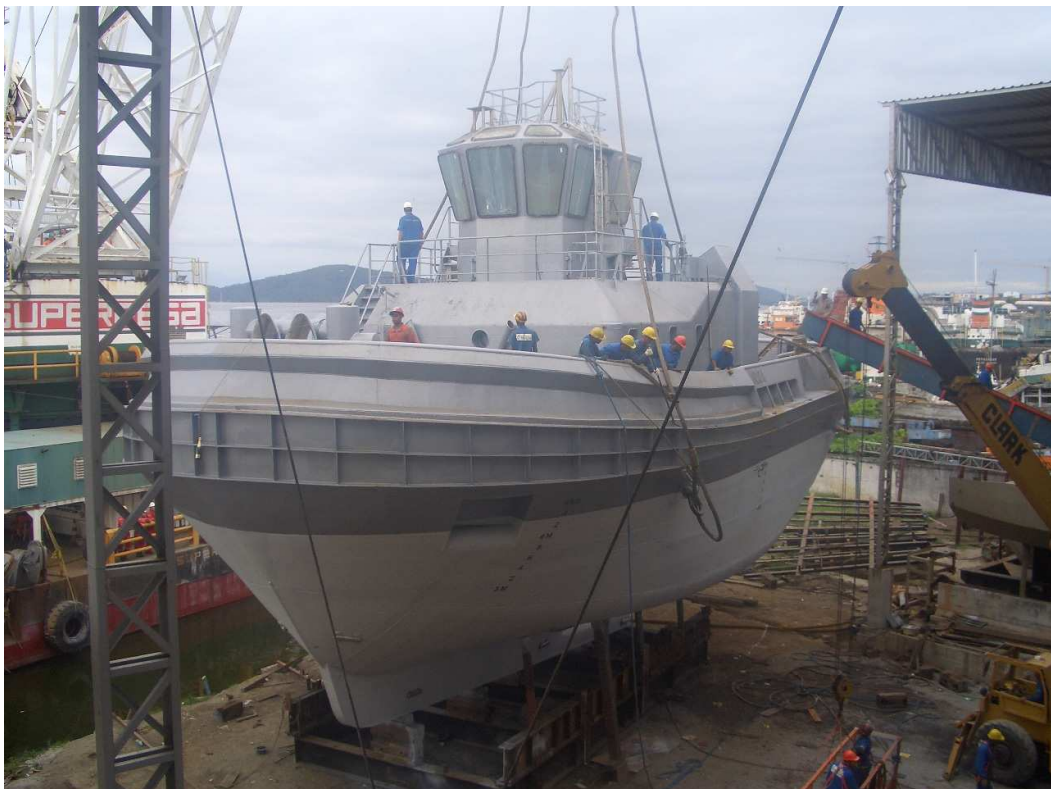
Figura 19 - Aplicação das tintas de fundo no navio.
