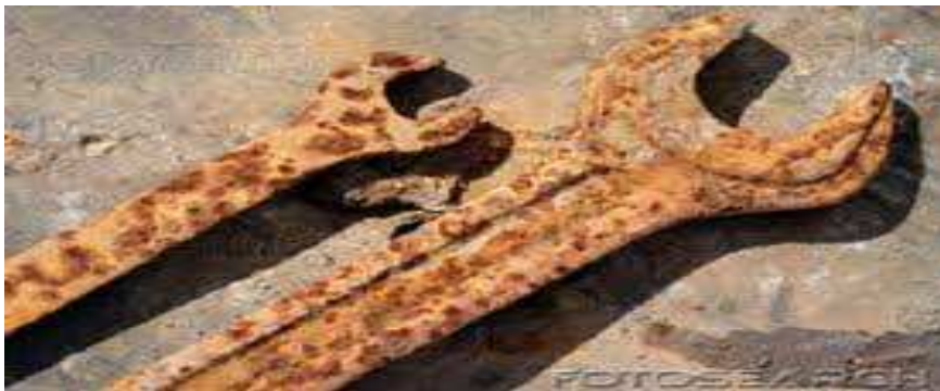
Figura 8 - Exemplo de corrosão química.
