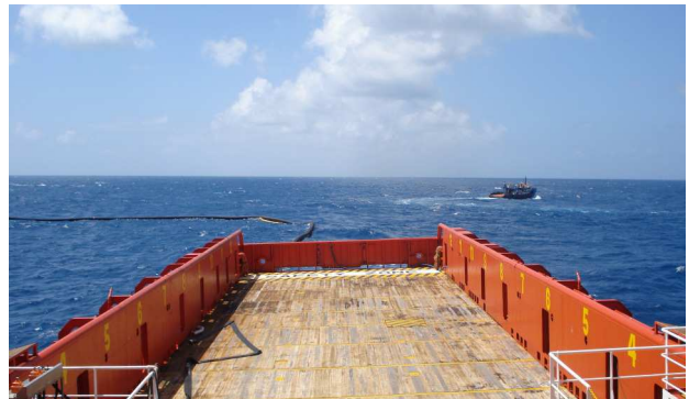
Figura 14 - Lançamento da Barreira em “J”
