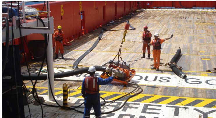
Figura 9 - Preparando Bomba de Vácuo do “Skimmer”
