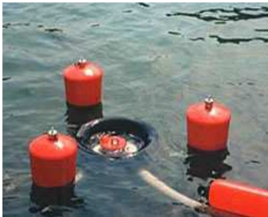
Figura 7 - “Skimmer” com Flutuadores Figura 8 - Bomba de Vácuo do “Skimmer”
