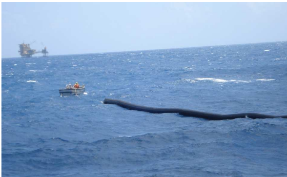
Figura 13 - Lançamento da Barreira
