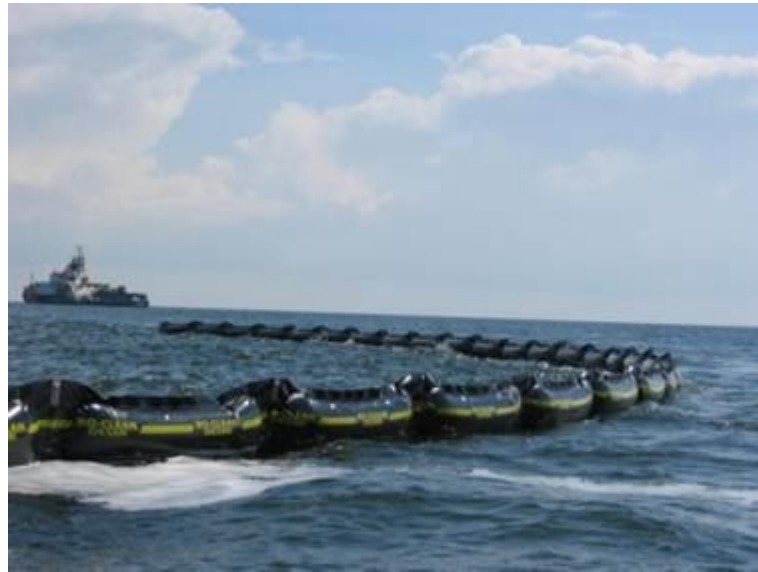
Figura 5: Barreira de contenção. Fonte: Geopoliticadopetroleo
