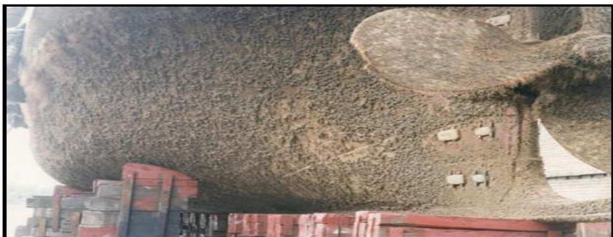
Figura 8 – Casco com incrustação. Fonte: AMBIO.
