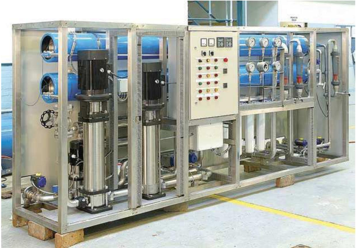
**Figura 7 – Sistema de Tratamento de Água de Lastro**
