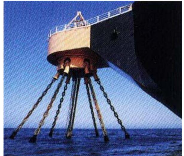
**SALM Buoy (Single Anchor Leg Mooring Buoy)** É um dos sistemas mais simples. Este sistema que usa uma mono bóia ancorada ao fundo por uma estrutura articulada é usado normalmente em locais onde não há uma grande incidência de mau tempo.
