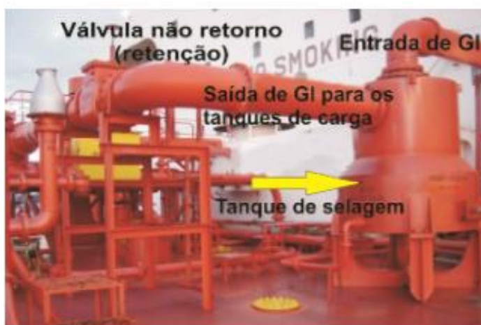
Figura 27: Sistema de Gás Inerte
