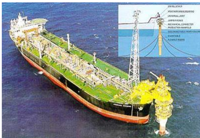
Figura 8: Movimentos de um Sistema Turret
