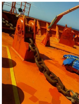
Figura 33: Chain Stopper travado
