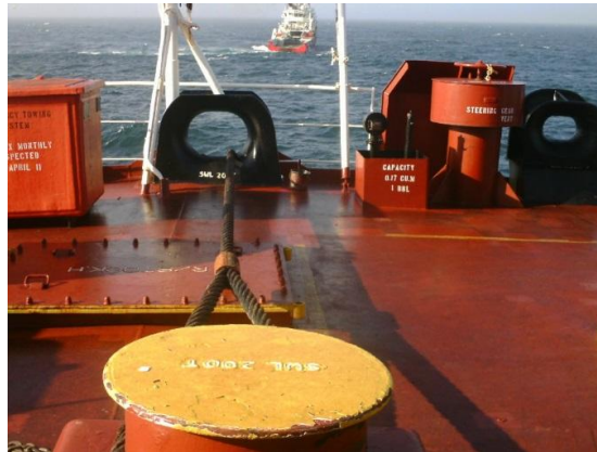
Figura 18: Buzina e Cabeço SWL 200 TON
