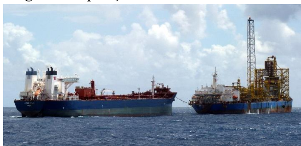
Figura 9: Operação de alívio com aliviador DP
