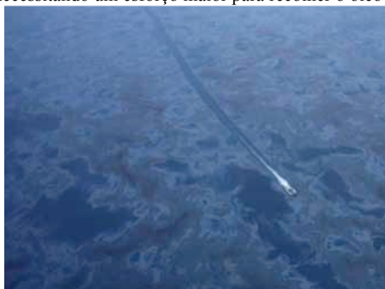
Figura 22: Conforme o óleo se espalha e começa a fragmentar, a taxa de encontro diminui, necessitando um esforço maior para recolher o óleo
