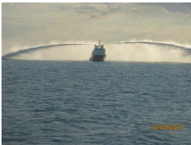
Figura 26: Dispersão mecânica com canhões Fire Fighting
