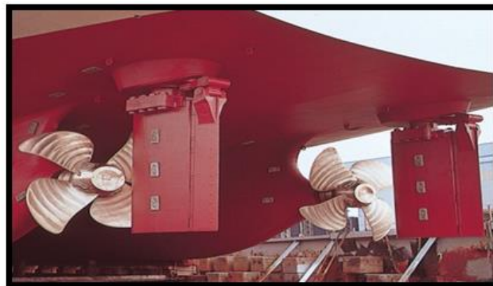
Figura 33: Propulsão dupla utilizando skegs
