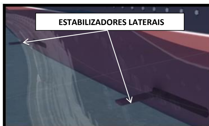
Figura 28: Estabilizadores laterais do Queen Mary II
