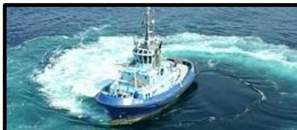
Figura 23: Rebocador utilizando cilindro rotativo
