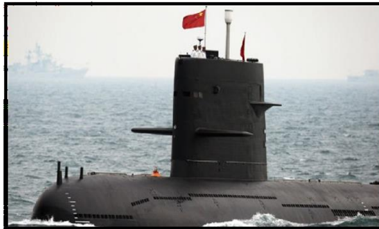
Figura 31: Estabilizadores do submarino Nuclear Chinês
