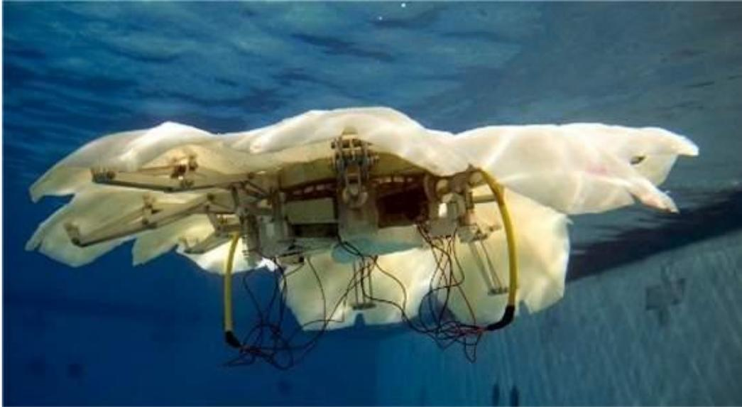
**Figura 08** : Robô água viva.
