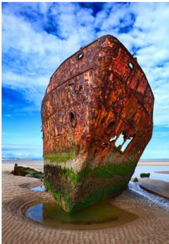
Figura 2 – Navio com um processo de corrosão acelerado
