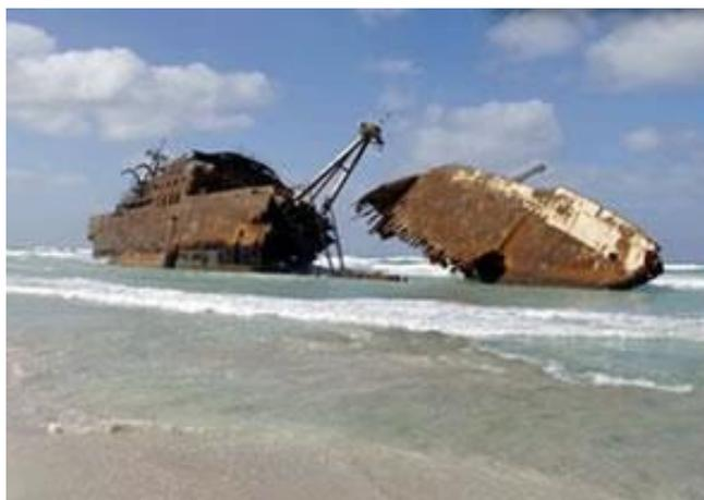
Figura 4 - Casco de navio corroído
