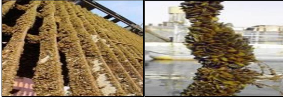
**Fig. 5 - Incrustação em grade de proteção de hidrelétrica e sobre Vegetação submersa. (Fonte: Furnas)**
