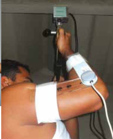
Figura 2: Célula de carga em série com a barra
