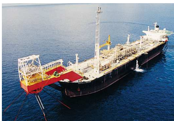
Figura 8: Navio plataforma (FPSO) com turret na proa
