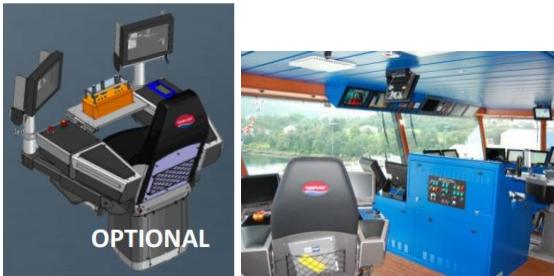
Figura 48 – Cadeira para comando do sistema TRIPLEX MDH no passadiço.
