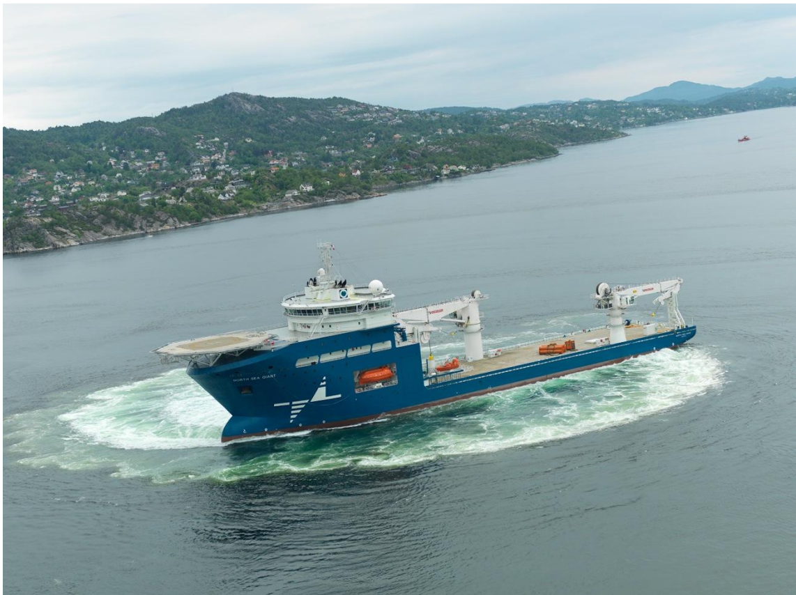
Figura 40 – OSC North Sea Giant. Maior embarcação offshore a utilizar VSP demonstrando sua capacidade de manobra.
