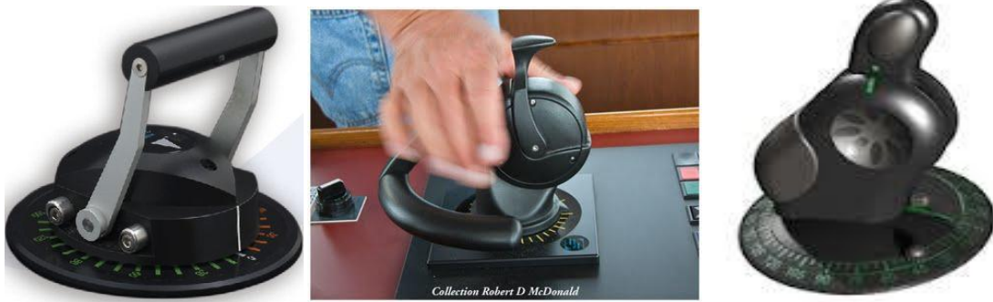
Figura 31 – Diferentes tipos de joysticks para propulsores azimutais.
