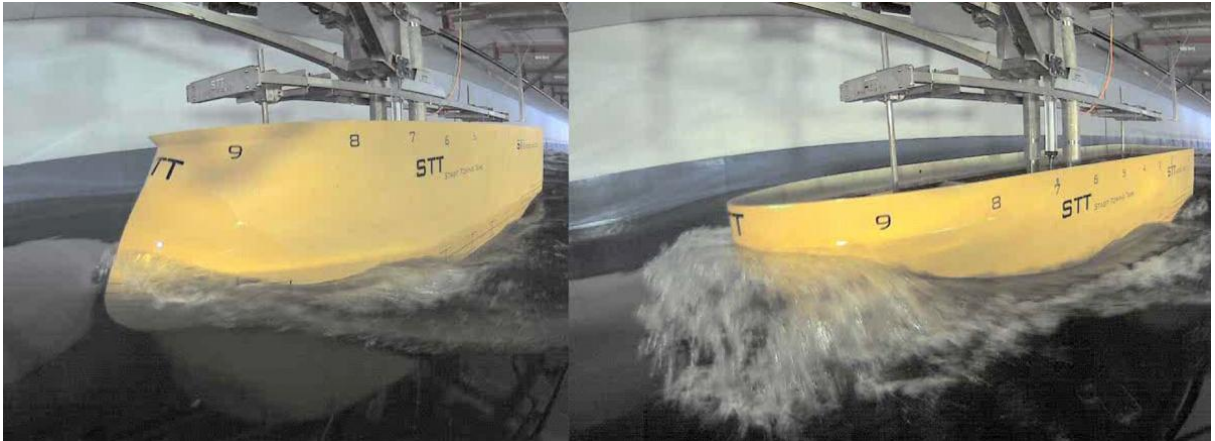
Figura 19 – Embarcação X-BOW à esquerda e embarcação de desenho convencional à direita.
