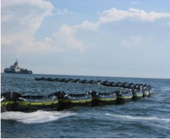
Figura 3 - Barreira de contenção.
