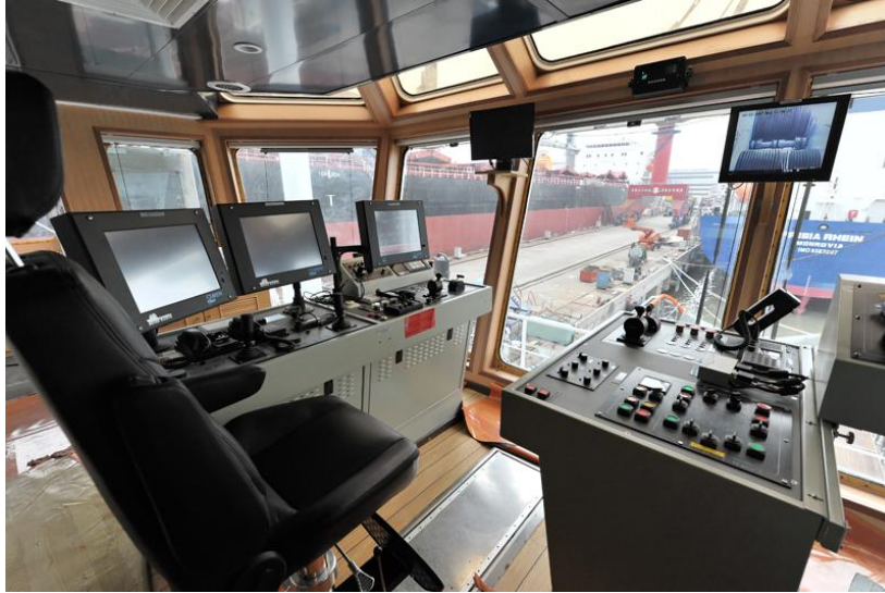
Figura 41 – Console do operador dos guinchos de um AHTS.
