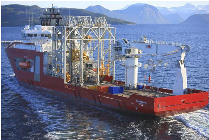
Figura 55 – Visualização da torre de lançamento de Árvores de Natal do Skandi Santos.
