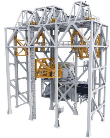
Figura 55 – Visualização da torre de lançamento de Árvores de Natal do Skandi Santos.
