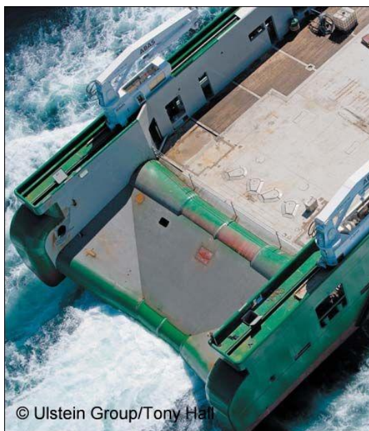
Figura 50 – Visão do sistema SAHS na popa do AHTS Bourbon Orca.
