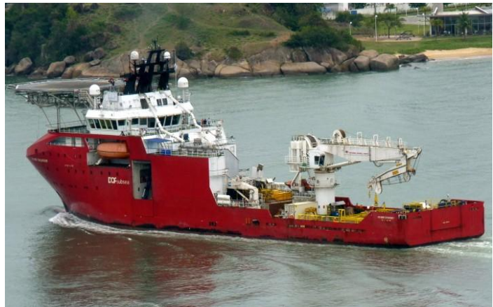
Figura 54 – Um guindaste com heave compensation e o guindaste com esta característica do OCV Skandi Salvador.
