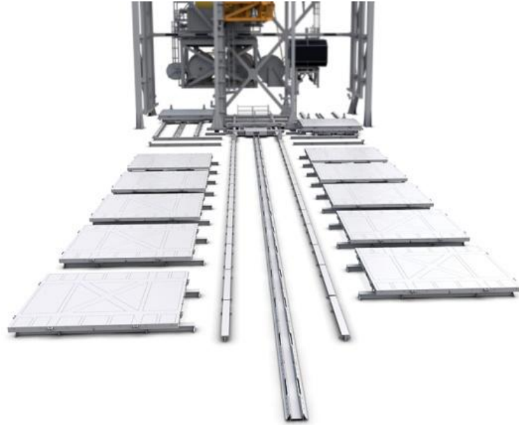
Figura 56 – Deck Skidding System em conjunto com a torre de lançamento.
