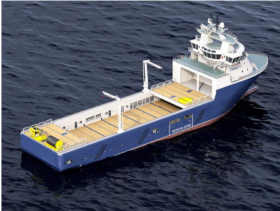
Figura 52 – Notar dois guindastes móveis e dois conveses superiores móveis no PSV.
