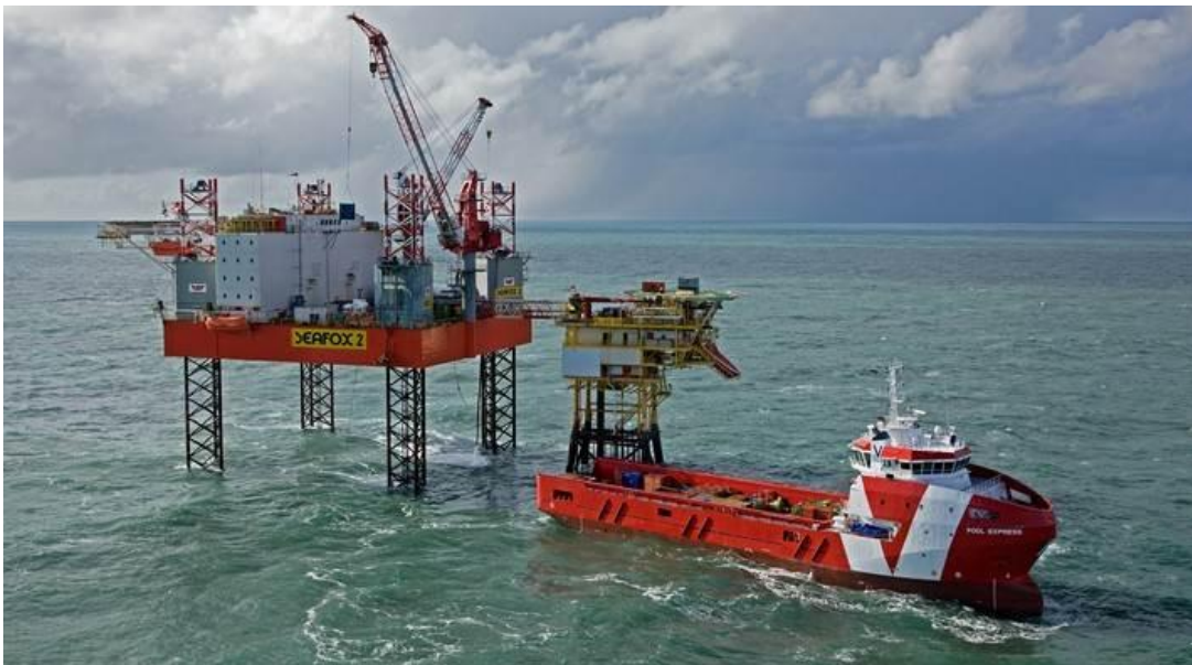
Figura 16 – PSV em operação de transferência de carga com plataforma.
