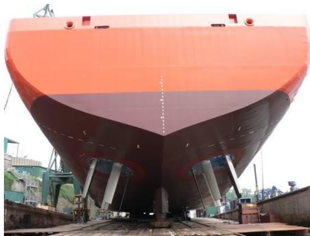
Figura 34 – PSV Edda Fram no dique seco, permitindo a visualização de seus dois VSPs.
