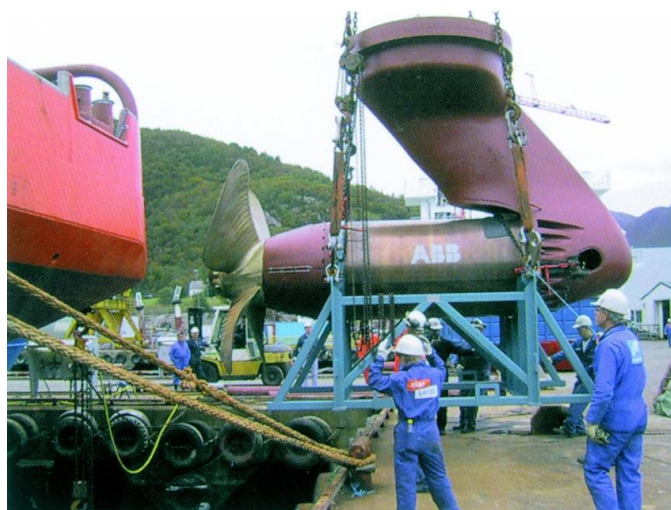
Figura 33 – Azipod sendo instalado no Normand Rover. Primeira embarcação offshore a receber o propulsor Azipod.
