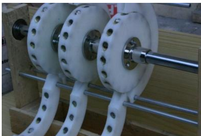
Figura 17: Protótipo de um motor magnético
