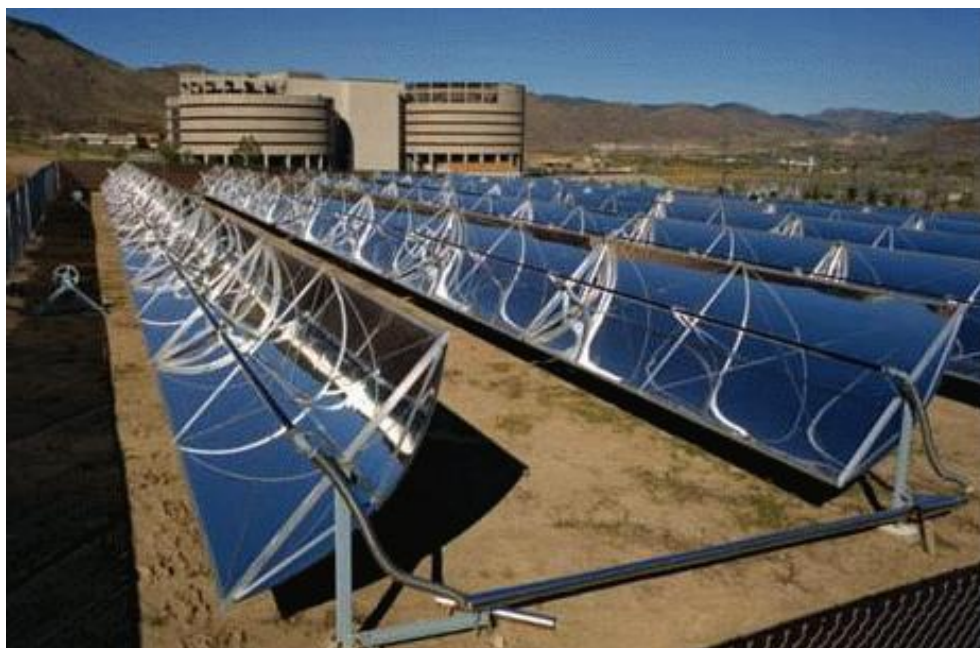
Figura 1 Concentrador solar com calhas parabólicas Fonte: www.ucsusa.org . Acessado em: 09/06/2015.
