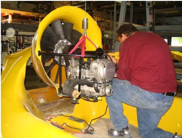
Figura 5: Instalação de um motor de propulsão de um hovercraft leve
