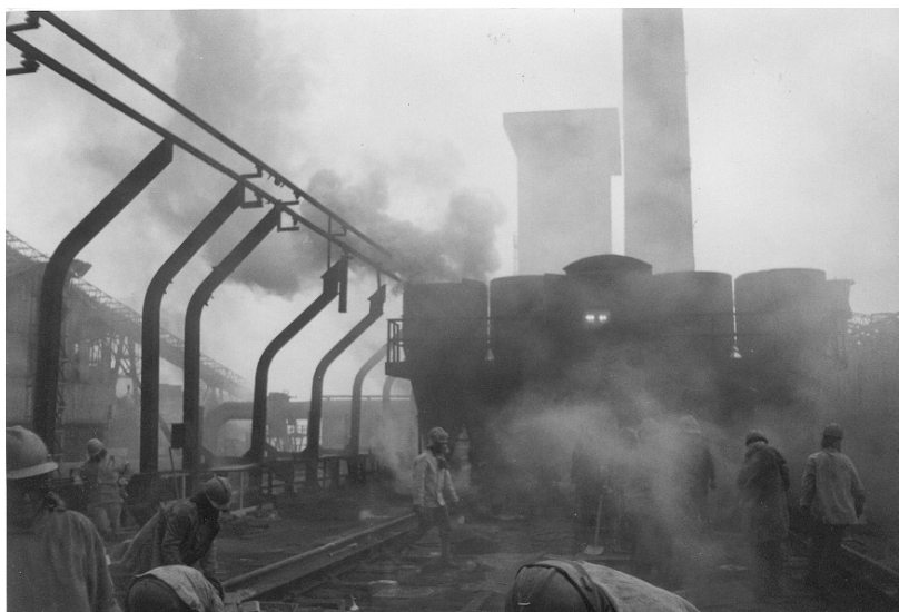
Figura 03: Máquina enforadora encoberta por vazamento de gás de coqueria Foto: Rui Magrini – 1996.
