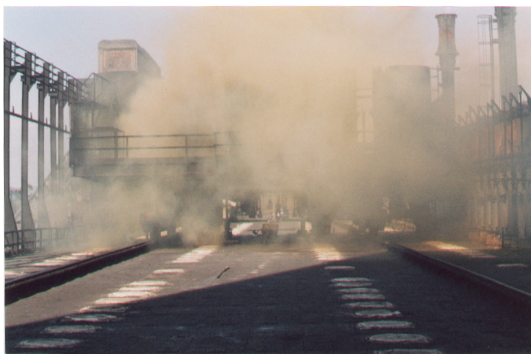
Figura 06: Vazamento de gás de Coqueria na Cosipa Foto: Danilo Costa - 1999.
