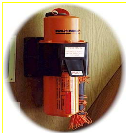
Figura 04: Dispositivo de localização para busca e salvamento. Fonte: Foto do SART retirada da plataforma SS-49.
