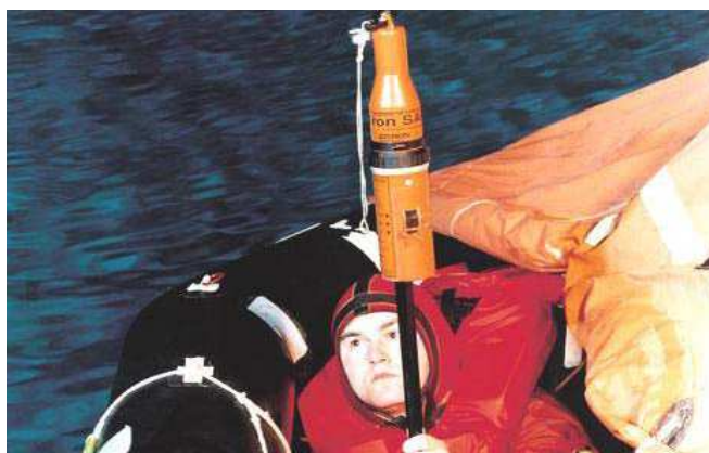
Figura 06: SART em uma embarcação salva vidas.
