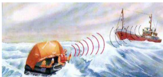
Figura 05: Equipamento SART sendo captado pelo radar banda X de uma embarcação. Fonte: imagem tirada da apresentação do professor CLC Marcus. Aula de Resgate.
