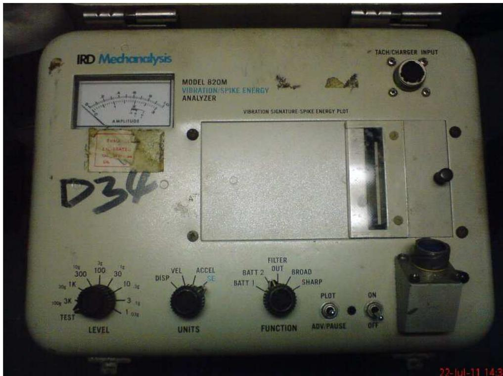
Medidor de vibração Original das Fragatas Classe Greenhalgh – Obsoleto/Avariado –
