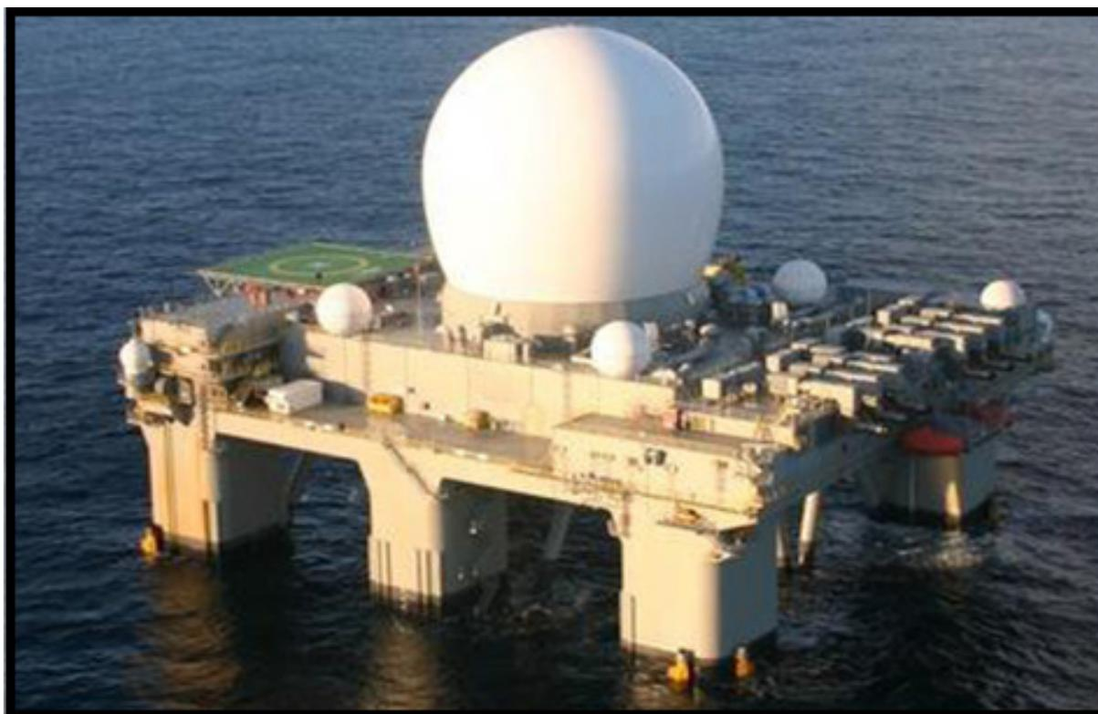
FIGURA 15 – SBX-1 estacionária e semi-submersa durante operação
