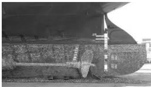
Cracas provocando corrosão
