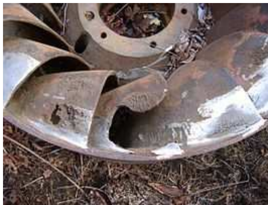
Exemplo de cavitação em turbinas
