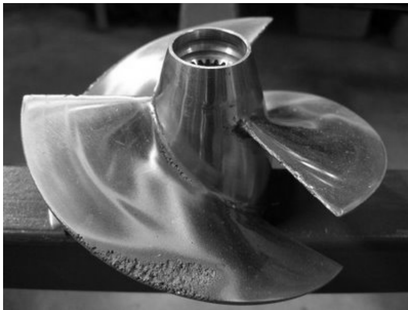
Danos da corrosão por cavitação no hélice
