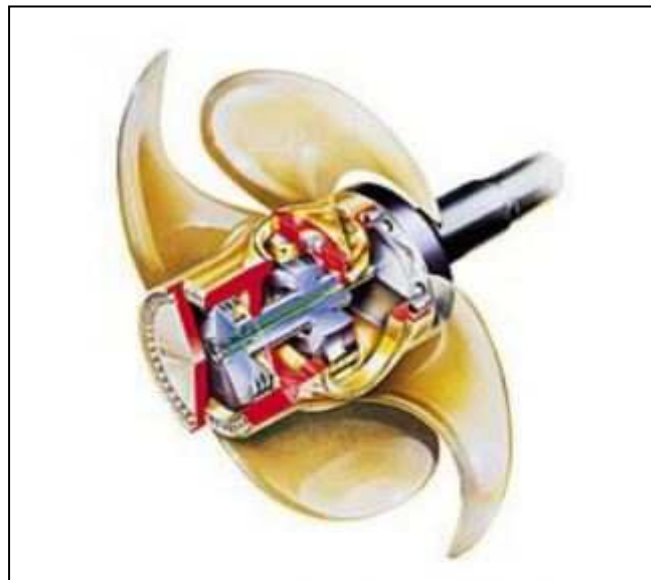
Figura 3 Hélice de passo controlável com detalhe interno
