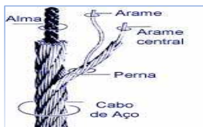
Figura 24 Composição de um cabo de aço (Fonte: < http://www.cabopec.com.br/portal/node/8 >)
