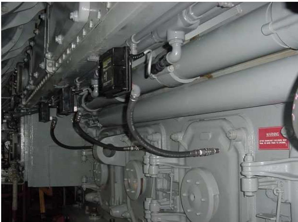
Figura 22 - Detector QMI instalado no motor
