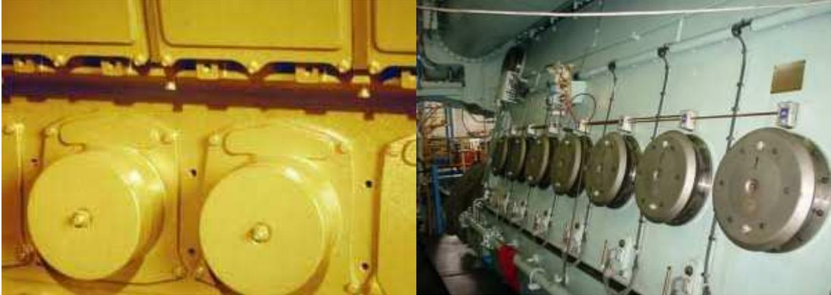
Figura 5 - Válvulas de segurança do cárter de motores diesel marítimos
