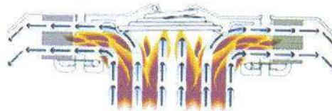
Figura 9 - Dispositivo ‘*corta-chamas*’ em ação
