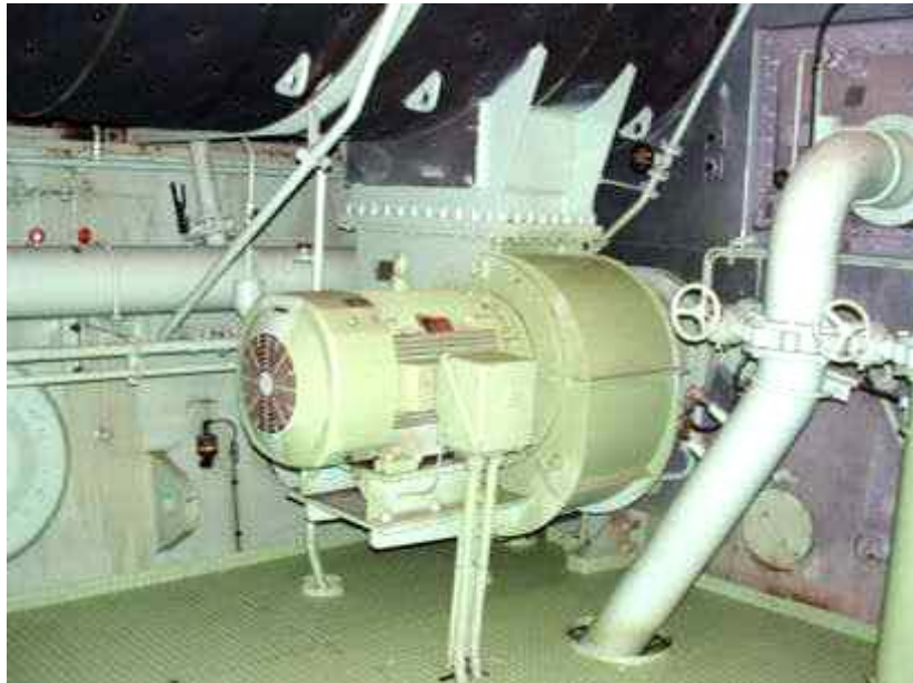
Figura 2.6- Auxiliary Blower Fonte: Marine Diesel Engine- Man B&W
