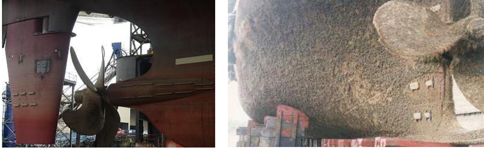
Figura 2.12- Casco do navio com incrustações Fonte: Maritime University of Szczecin Poland
