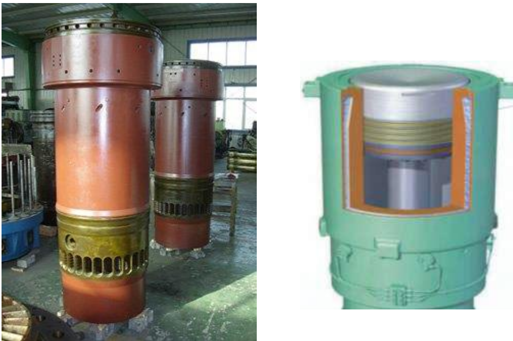
Figura 2.2- Camisa do cilindro e sistema de resfriamento da camisa Fonte: MAN B&W
