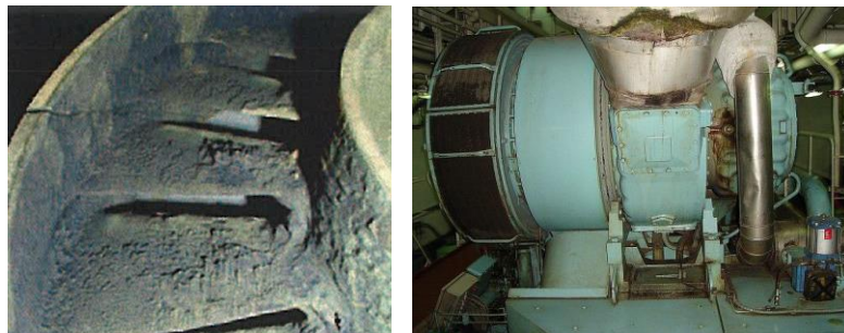
Figura 2.10- Incrustações e lavagem da turbina Fonte: Maritime University of Szczecin Poland
