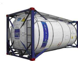
Têm vinte pés de comprimento e podem transportar carga a granel seca, gasosa ou líquida. São descarregados com a injeção de gases pressurizados.
