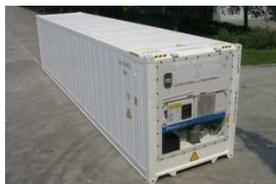
Têm uma unidade de refrigeração integrada que faz parte da estrutura dos equipamentos. Suas dimensões atendem os padrões ISO. É usado no transporte de cargas que necessitam refrigeração. Pra que a refrigeração seja plena deve ser deixado um espaço acima das cargas para a circulação do ar frio, esse espaço é chamado plenum.
