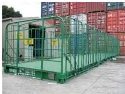
São usados no transporte de animais vivos. Eles têm divisórias, boa ventilação, iluminação e conexões para a instalação hidráulica e rede elétrica.
