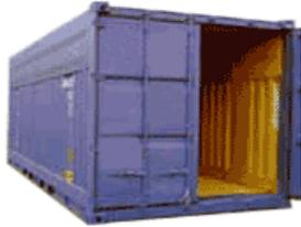
São usados no transporte de cargas perecíveis que necessitam de ventilação para a remoção de calor e dissipação de gases, bem como suprir de ar seco para a prevenção da condensação. A ventilação pode ser natural, com câmaras que criam o efeito chaminé ou com o uso de ventiladores elétricos que promovem a circulação do ar.
