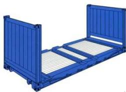
Usados no transporte de cargas que ultrapassam a altura e a largura de contêineres comuns. Os flats racks possuem cabeceiras que podem ser fixas ou rebatidas, formando um contêiner plataforma. Ou podem ser dotados, em vez de cabeceiras, de postes ou montantes, fixos em cada canto.
