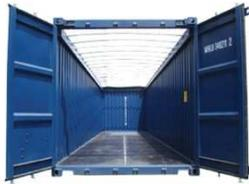
São usados para ovar cargas que, excedam a altura do contêiner. Depois de estivada a carga, ela é coberta com capas de PVC para que seja mantida sua impermeabilidade. Nenhum outro contêiner pode ser estivado sobre ele, quando a carga ultrapassar a sua altura. Podem ter quarenta ou vinte pés de comprimento.
