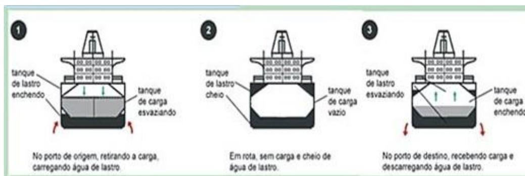
Figura 4 - Processo da água de lastro
