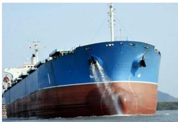
Figura 5 - Navio despejando água de lastro
