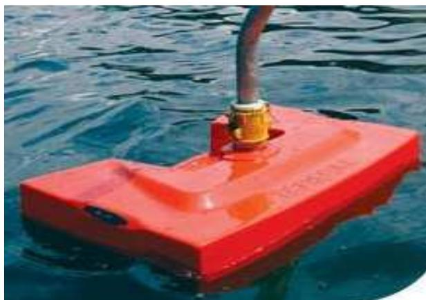
**Figura 9: Skimmer recolhedor de óleo tipo vertedouro**
