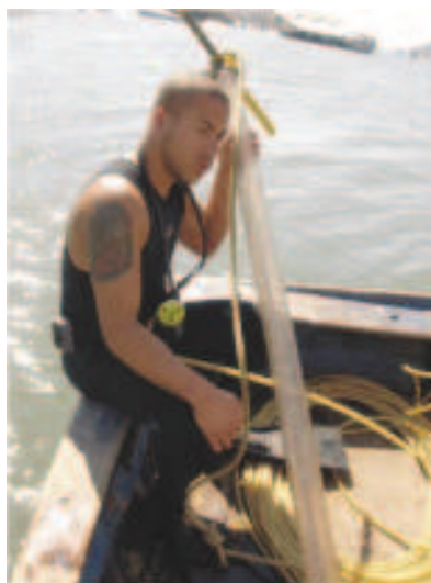
Coleta dos testemunhos de sondagem com Piston corer manual, com tubo de acrílico de até 3 m de comprimento.
