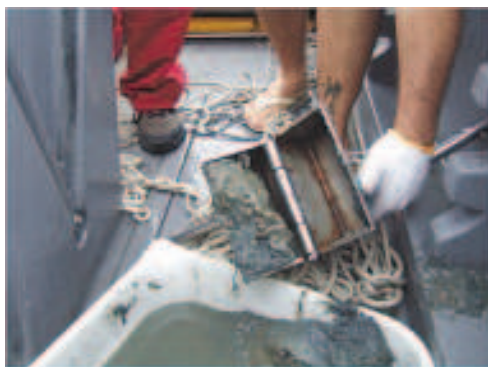
Coleta de sedimentos lamosos com Van-Veen contendo sedimentos lamosos para a realização das análises granulométricas, químicas e ecotoxicológicas
