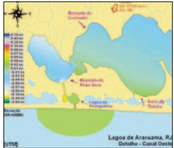
Figura 7 – Isolinhas de nível em baixamar, com canal oeste.
