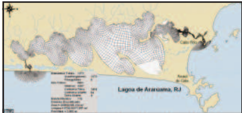
Figura 5 – Domínio modelado discretizado em elementos finitos.
