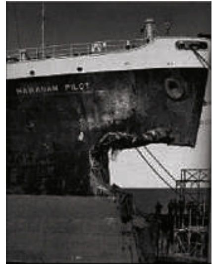
Proa do SS HAWAIIAN PILOT, após a colisão.
