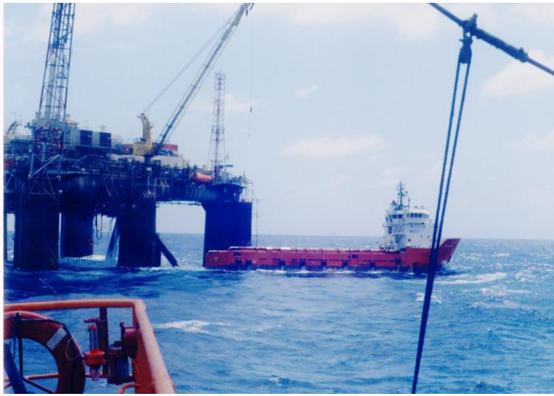
Figura 2 - Embarcação de apoio marítimo, EAM, também chamada de rebocador “off-shore”, em faina de abastecimento da plataforma.
