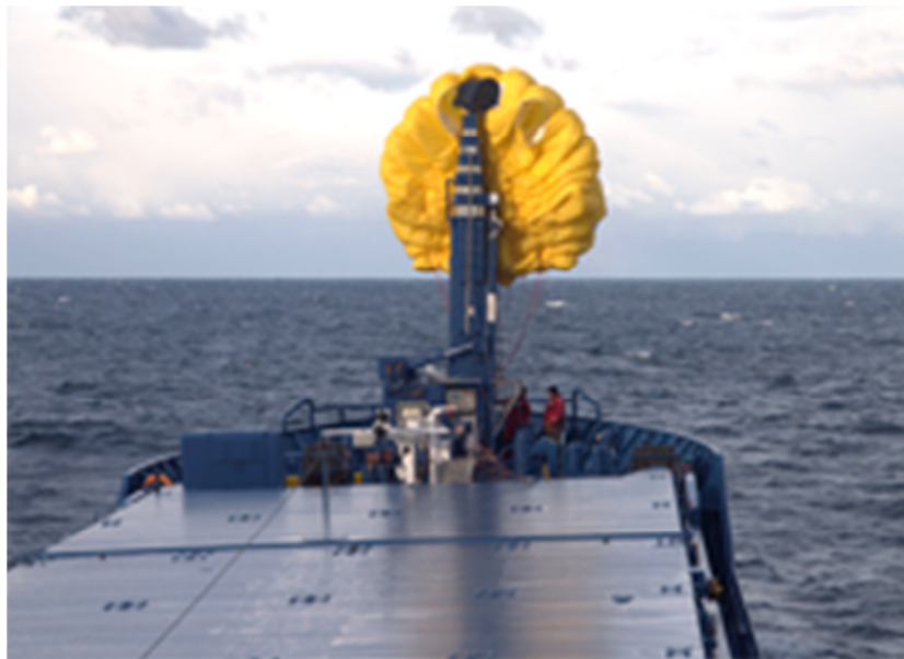
Figura 3.2 – Levantamento da torre da vela num mastro da proa
