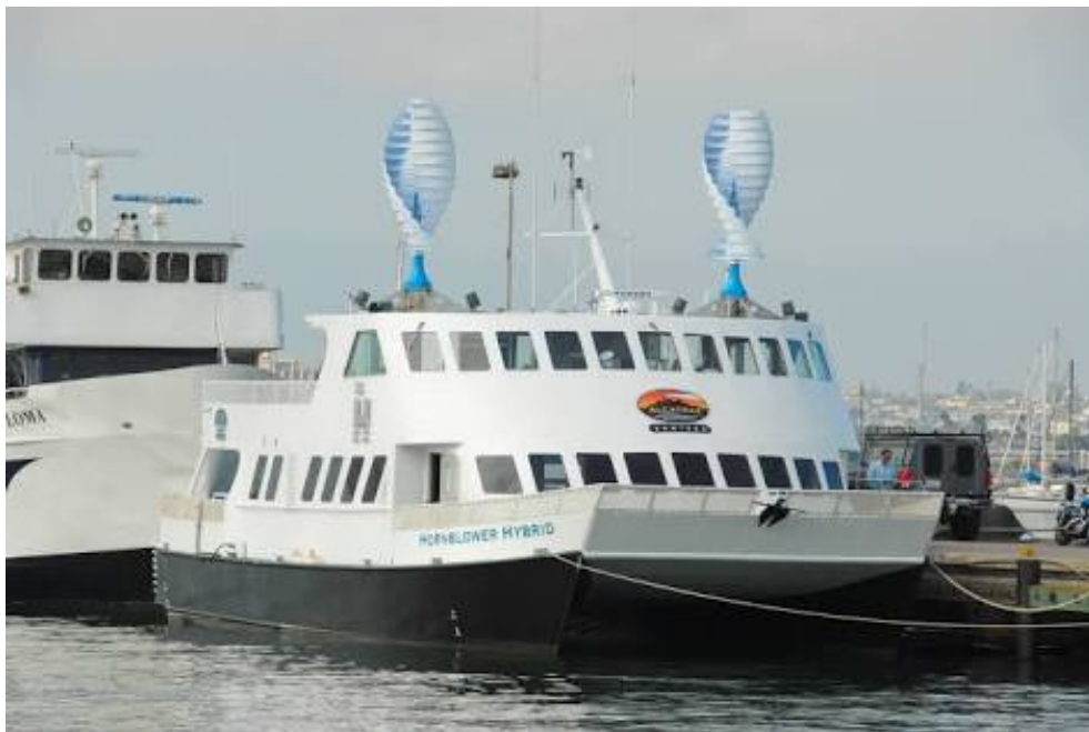
Figura 3.7 – Ferry Hornblower Hybrid com duas turbinas do tipo Savonius
