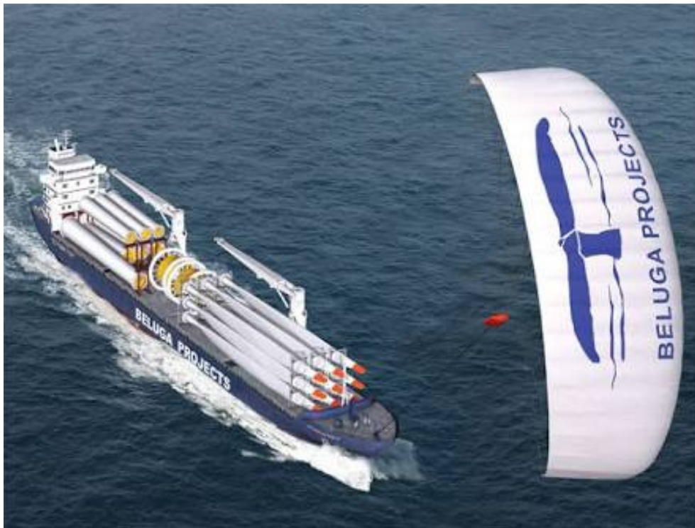
Figura 3.5 – Vela, tipo kite, com o navio já navegando em velocidade de cruzeiro
