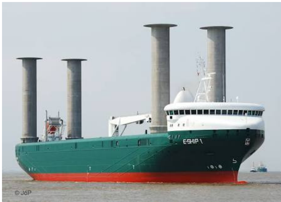
Figura 3.6 – Navio “E-Ship” com suas quatro turbinas Flettner
