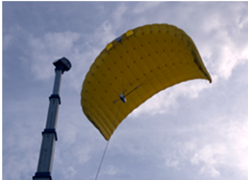
Figura 3.4 – Vela, tipo kite, já com o cabo solecado em modo normal de operação
