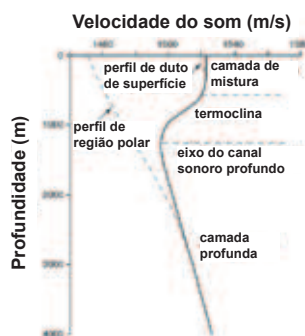
Figura 4: Perfil da velocidade do som em águas profundas (Munk). Adaptado de JENSEN et al. [4]
