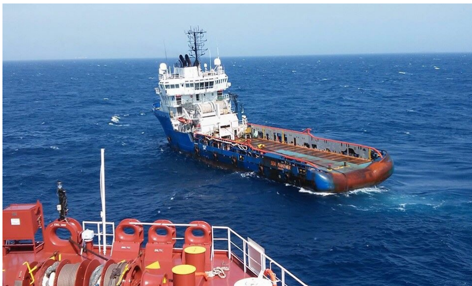
Figura 5: Rebocador de apoio segurando a popa do navio aliviador.
