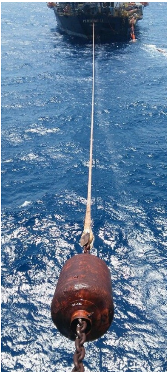
Figura 8: Sistema de amarração ao navio aliviador. “Cabo Sansom”.
