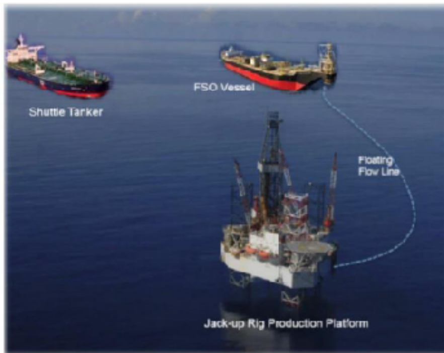
Figura 19: Esquema do recebimento da produção de petróleo da Plataforma FSO através de uma Plataforma auto elevável.
