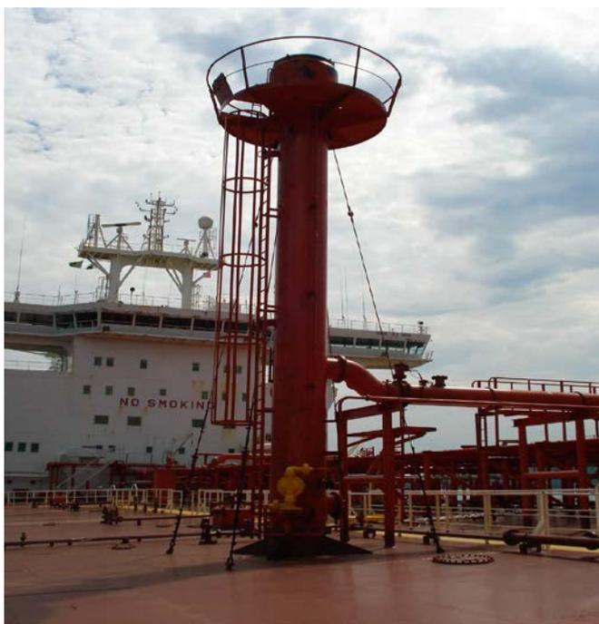
Figura 12: Poste de Ventilação (Vent Riser)
