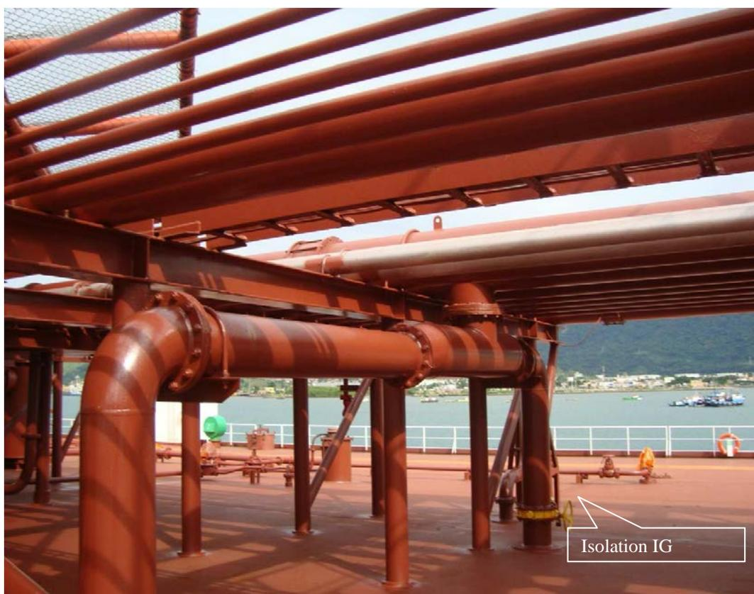
Figura 11: Válvula de Isolamento linha gás inerte de um tanque de carga.
